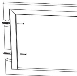
6) Forare e fissare i profili al vano. Regolare il profilo compensatore inserendo, nel foro apposito, un chiavino a brugola agendo sul registro già inserito nel profilo.
