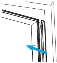
9) Inserire i pannelli mobili infilando prima una delle due parte laterale (assicuratevi che il pannello si incastri con il telaio ) e poi, con una leggera pressione, inserire la parte opposta.
