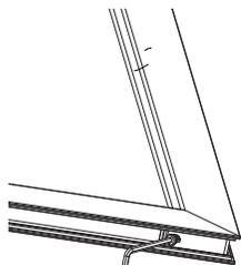
5) Far aderire i profili al vano e forarlo tramite i fori praticati al passo 1. Fissare i profili al vano.
