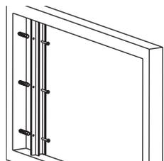
7) Inserire il telaio nel compensatore.
