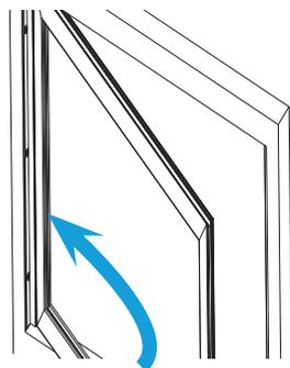
8) Infilare il secondo compensatore sul lato opposto del telaio e in serire il tutto nel vano. Forare e fissare il secondo profilo.
